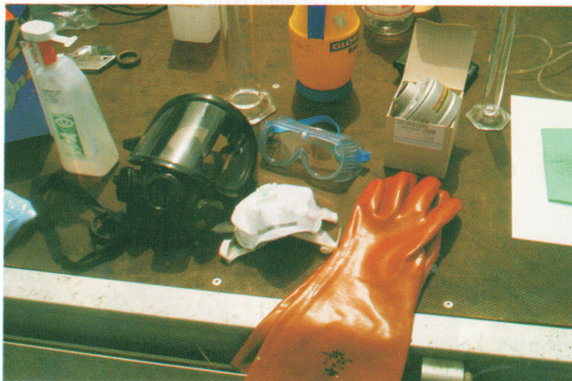
Slika 25. Zaštitna oprema koju je potrebno nositi za vrijeme aplikacije organskih kiselina (zaštitne naočale, zaštitne rukavice otporne na djelovanje kiselina, zaštitna maska za dišne puteve, te tekućina za ispiranje)
